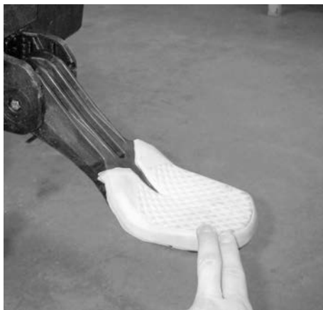
ПОСАДОЧНАЯ ПОДНОЖКА ДЛЯ ПОДЪЕМА ИЗ ВОДЫ, УДЕРЖИВАЕМАЯ В НИЖНЕМ ПОЛОЖЕНИИ
