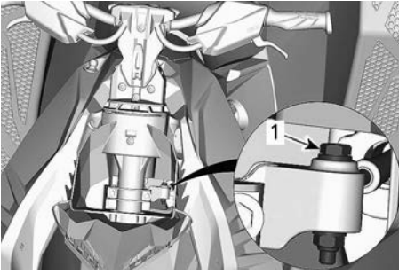
1. Parafuso de fixação do cabo de direção
