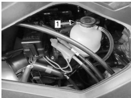
1. Tampa do tanque de expansão
