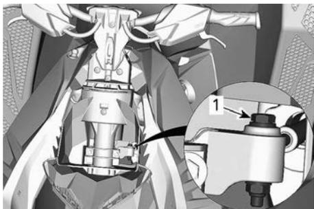
1. Bullone di fissaggio del cavo dello sterzo
