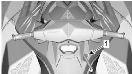
Per consentire al motore di avviarsi, il cappuccio del cordoncino di sicurezza deve essere saldamente fissato all'interruttore di spegnimento del motore.
