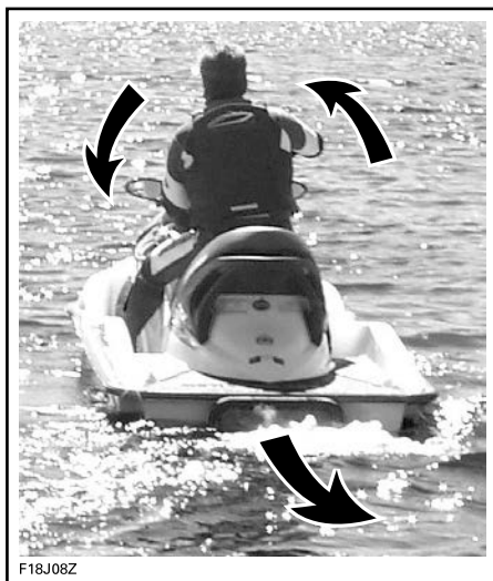
TYPBILD - STYRRIKTNINGEN OMKASTAD VID BACKNING
