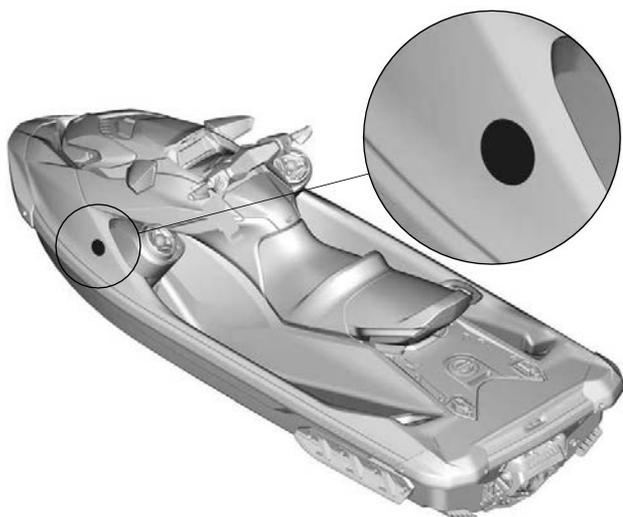
ТИПОВОЙ ВАРИАНТ – РАСПОЛОЖЕНИЕ НАКЛЕЙКИ
