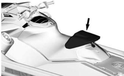
Седло сиденья обеспечивает опору, чтобы бедра водителя надлежащим образом входили в сиденье Ergolock, что увеличивает его эффективность и позволяет водителю выдерживать большее боковое ускорение за счет передачи усилия на таз, а не верхнюю часть корпуса.
