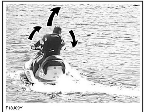
Поворот руля приводит к повороту сопла водомета, что задает направление движения. Отклоняя руль вправо, Вы будете поворачивать моторное судно вправо, и наоборот. Чтобы изменить направление движения, необходимо нажимать на рычаг дроссельной заслонки.
