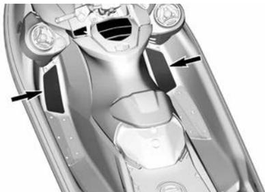
Наклонные подножки для водителя являются уникальными для данного моторного судна и позволяют фиксировать тело при прохождении крутых поворотов.
