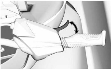
Рычаг дроссельной заслонки подпружинен и при отпуске должен возвращаться в исходное положение, соответствующее оборотам холостого хода.
