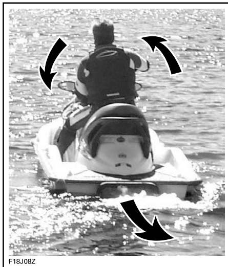
TYPEBILDE – STYRERETNINGEN ER MOTSATT NÅR DU RYGGER
