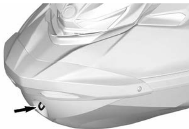
TYPEBILDE – FREMRE SLEPEØYE
