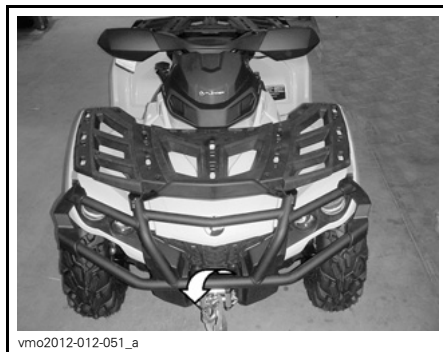
TÍPICO - LOCALIZAÇÃO DO PONTO DE SUJEIÇÃO DIANTEIRO
