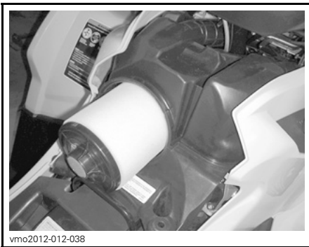
REMOÇÃO DO FILTRO DE AR
