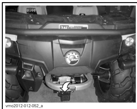
TÍPICO - LOCALIZAÇÃO DO PONTO DE SUJEIÇÃO TRASEIRO
