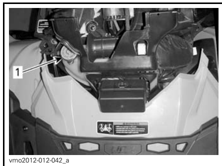
1. Réservoir de liquide de refroidissement
