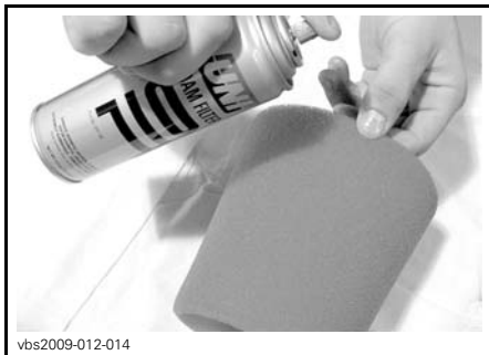
TIPIQUE - LUBRIFICATION DU FILTRE EN MOUSSE
