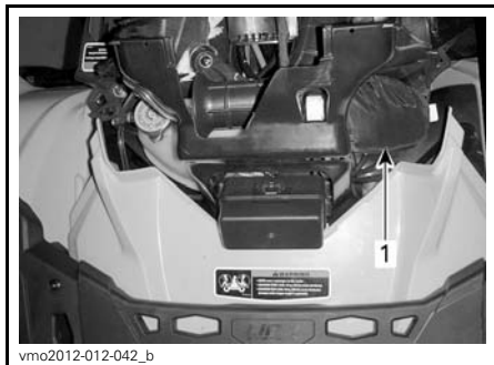
1. Filtre à air de la transmission CVC
