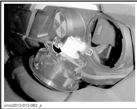
vmo2012-012-062_a FAIRE TOURNER L'AMPOULE DANS LE SENS ANTIHORAIRE
