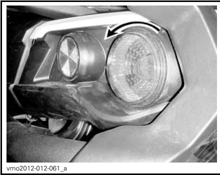
vmo2012-012-061_a FAIRE TOURNER L'AMPOULE DANS LE SENS ANTIHORAIRE POUR L'ENLEVER
