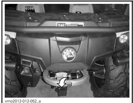
TYYPILLINEN - KIINNITYSKOHTA TAKANA
