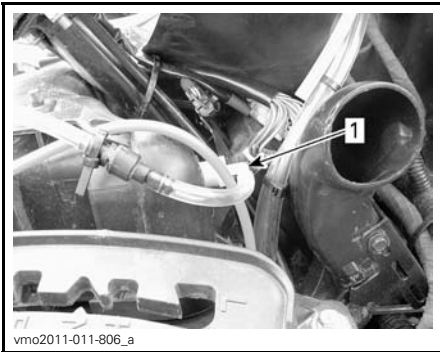
1. ACS-kompressorns luftfilterinlopp till luftfilterhusets lock.
