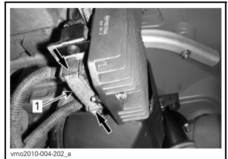
TYPEBILDE – OUTLANDER 800R LTD VIST 1. Sikringsholder bak
