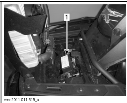
TYPEBILDE – OUTLANDER 800R LTD VIST 1. Sikringsholder bak
