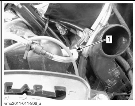
1. Luchtfilterinlaat ACS-compressor in deksel luchtfilterhuis
