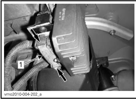
TYPIQUE - VUE DU OUTLANDER 800R LTD 1. Porte-fusibles arrière
