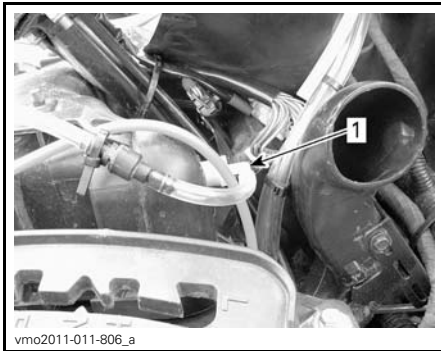
1. Admission du filtre à air du compresseur ACS dans le couvercle du boîtier de filtre à air
