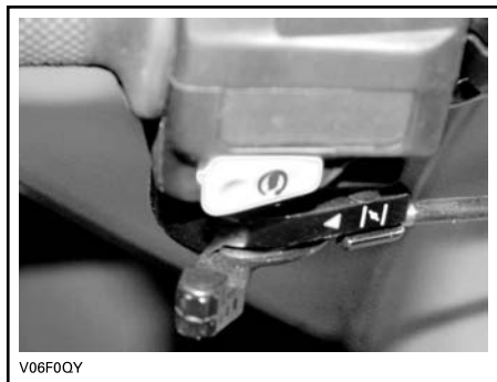
РУКОЯТКА ВОЗДУШНОЙ ЗАСЛОНКИ В ПОЛОЖЕНИИ «FULL»
