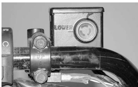
TIPIQUE — RÉSERVOIR DE LIQUIDE DE FREIN ARRIÈRE
