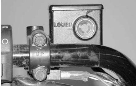
TÍPICO — DEPÓSITO DE LÍQUIDO DE FRENOS DE LA PARTE TRASERA, EN EL LADO IZQUIERDO
