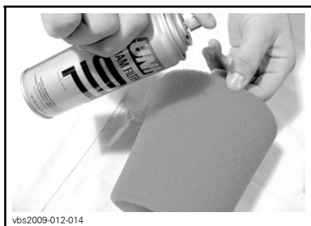
TYPISCH - ÖLEN SIE DAS SCHAUMFILTERELEMENT
