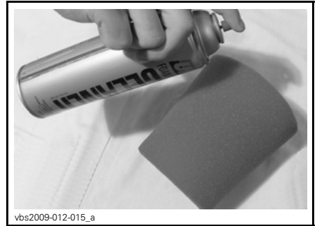
TYPISCH - SCHAUMSTOFFFILTERELEMENT BESPRÜHEN
