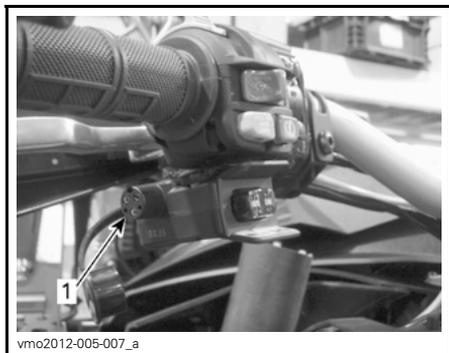
1. Conexão do controle remoto
