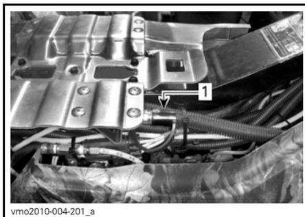
1. Conexão do compressor
