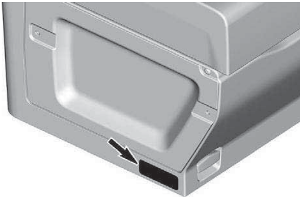
BASE DE L'ANCRAGE D'ACCESSOIRE
