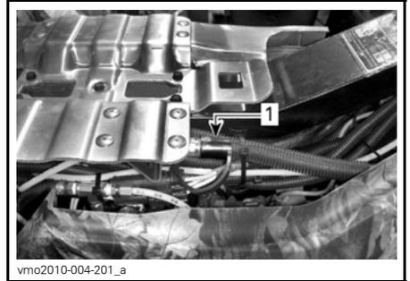
1. Acoplamiento del compresor
