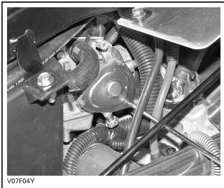
Inserte la aguja de la lata del lubricante en el extremo del ajustador del cable del estrangulador.
