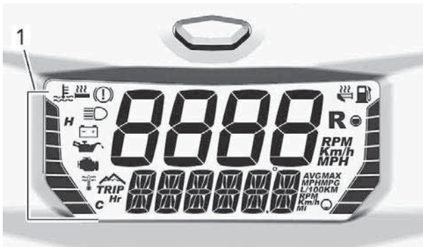
1. Левый указатель панели приборов
