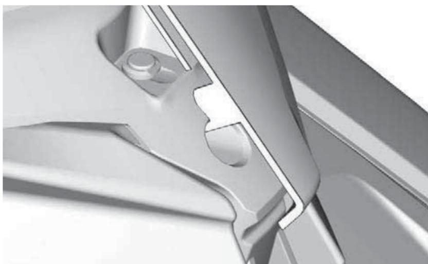
3. Befestigen Sie die Windschutzscheibe, indem Sie deren Stifte in die Durchgangsstüßen stecken.
