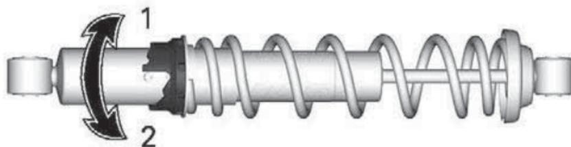
1. Vorspannung erhöhen
