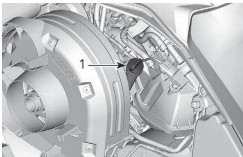
**LINKE SEITE DES FAHRZEUGS****1. Öltank-Messstab**
