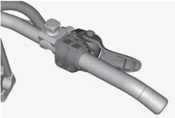
**GASHEBELPOSITION FÜR FINGERBETÄTIGUNG**
