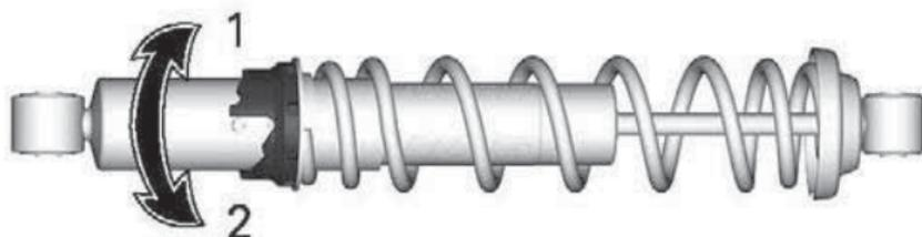
1. *Vorspannung erhöhen*
