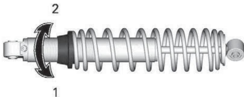
1. Vorspannung erhöhen
