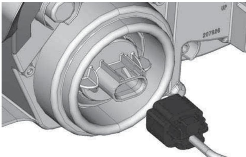
9. Entriegeln Sie die Glühlampe durch Drehen entgegen dem Uhrzeigersinn.
