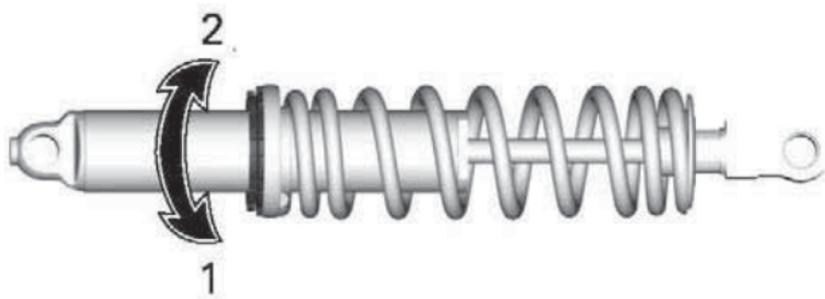
1. *Vorspannung erhöhen*
