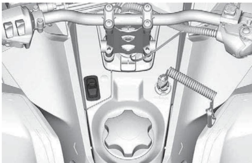
Drücken Sie einmal auf das untere Ende des Schalters, um aus dem Sport-Modus heraus den Standard-Modus zu aktivieren.
