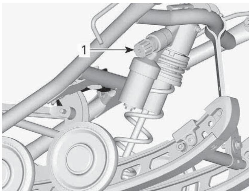
1. Einstellknopf für Kompressionsdämpfung des mittleren Stoßdämpfers
