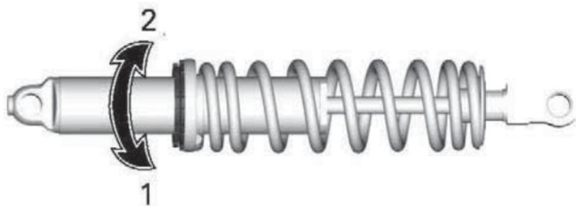
1. Vorspannung erhöhen
