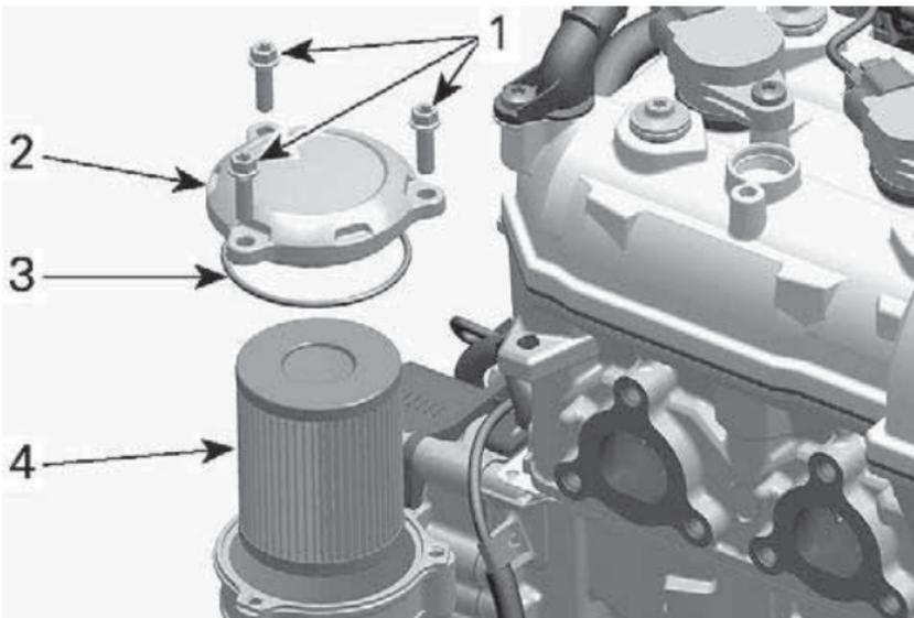
1. Schrauben der Ölfilterabdeckung
