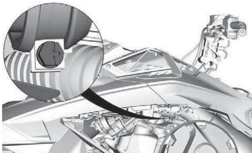
10. Entfernen Sie die Halteschrauben der oberen Karosseriebaugruppe auf beiden Seiten.
