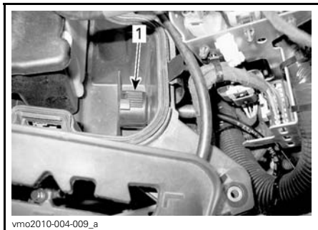
1. Luftfilter for ACS-kompressor
