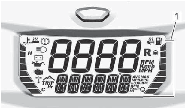
1. Søylemåler høyre side
