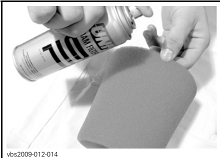
TYPISCH - FILTERELEMENT MET OLIE SMEREN
