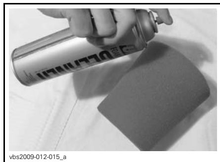
TYPIQUE - IMPRÉGNER L'ÉLÉMENT EN MOUSSE
