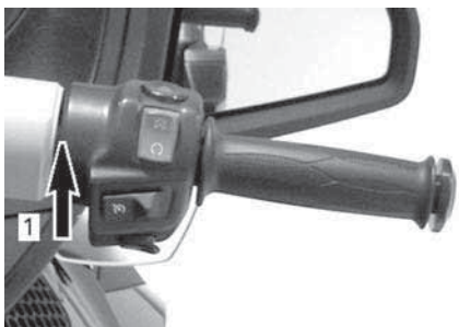
1. Työnnä painiketta ylöspäin lisätäksesi ajonopeuden säätöä
