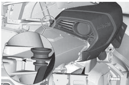
ТИПОВОЙ ВАРИАНТ — ПРАВИЛЬНОЕ ВЫРАВНИВАНИЕ ПАНЕЛЕЙ
