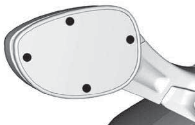
ТОЧКИ РЕГУЛИРОВКИ ЗЕРКАЛ — МОДЕЛИ STD И S
