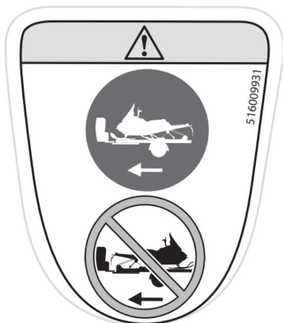
**KORREKTE ABSCHLEPPRICHTUNG – WARNSCHILD**
