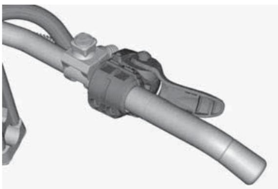
**GASHEBELPOSITION FÜR FINGERBETÄTIGUNG**
