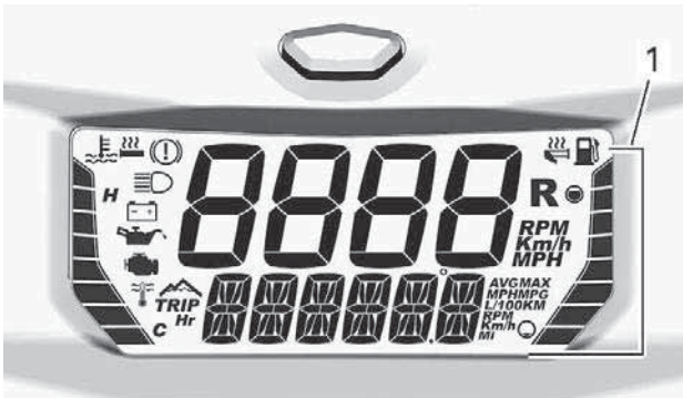
1. Søylemåler høyre side
