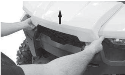
DE RAND VAN HET VOORSTE ONDERHOUDSDEKSEL OPTILLEN.
