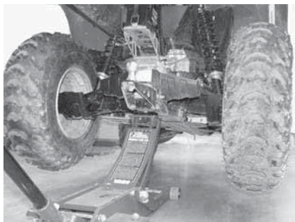
BILDET VISER – LØFTEPUNKT BAK PÅ KJØRETØYET
