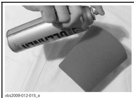
TYYPILLINEN - SUIHKUTA VAAHTOMUOVIPANOS SISÄ- JA ULKOPUOLELTA
