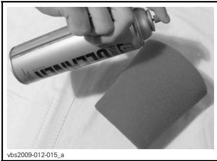
vbs2009-012-015_a TÍPICO - ROCÍE EL ELEMENTO DE FILTRO POR DENTRO Y POR FUERA
