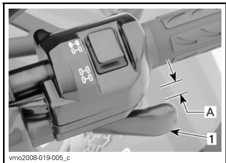
1. Palanca del acelerador A. 3 mm a 6 mm
