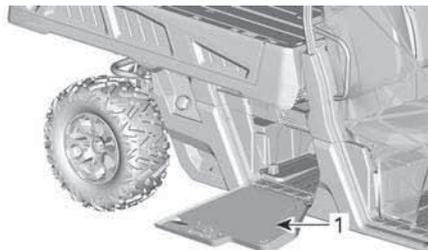
Desmonte la tapa de la batería desatornillando los dos fijadores de 1/4 de vuelta.
