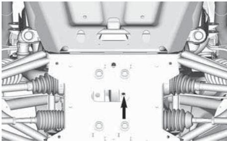
4. Coloque una bandeja de drenaje debajo del diferencial trasero.
