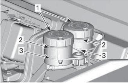
1. Depósitos de líquido de frenos
