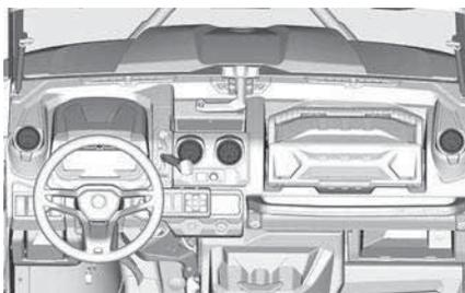
Presione el punto moldeado para abrir la ventilación.
