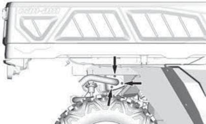
2. Retire el tubo de escape, la junta (deséchela) y el supresor del silenciador.
