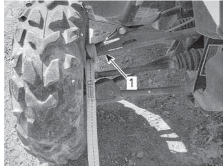
1. Верхний рычаг передней подвески
