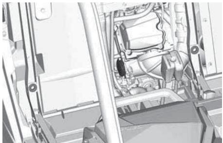
3. Снимите крышку масляного фильтра.
