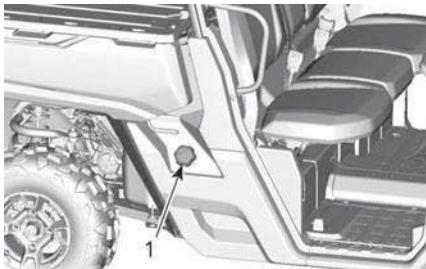
**ТИПОВОЙ ВАРИАНТ****1. Пробка топливного бака**
