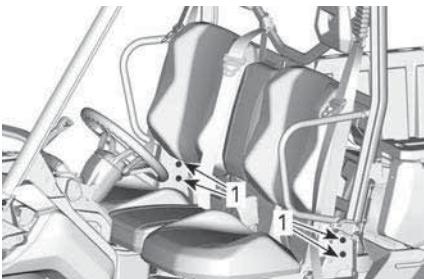
1. Элементы крепления верхней рамы каркаса безопасности
