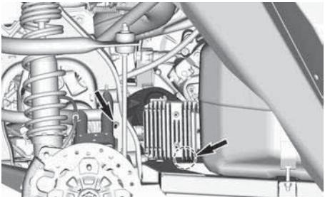
**МЕСТОПОЛОЖЕНИЕ КРЕПЕЖНЫХ ЭЛЕМЕНТОВ ОПОРЫ РЕГУЛЯТОРА НАПРЯЖЕНИЯ**
