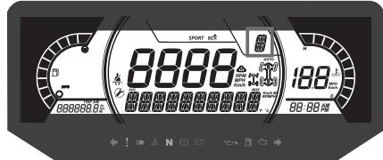
Отображает положение передач:
