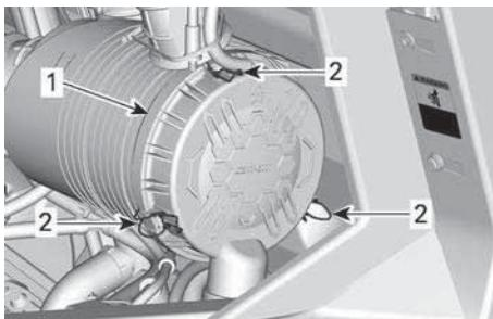
1. Крышка корпуса воздушного фильтра
