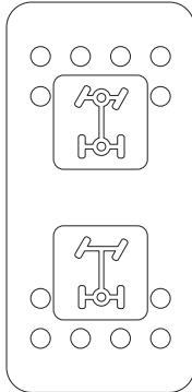
С помощью этого переключателя можно выбирать режим 2-колесного или полного привода, когда транспортное средство остановлено.
