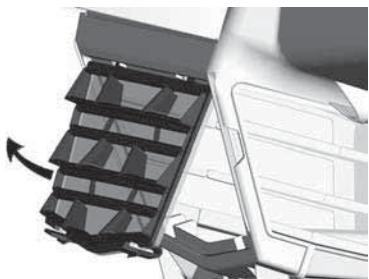
Очистите воздушный фильтр, промыв его в теплом слабом мыльном растворе. Перед установкой удалите лишнюю воду и просушите на воздухе.
