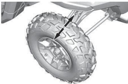
**ТИПОВОЙ ВАРИАНТ****Колеса и шины****Снятие колеса**
