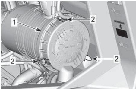
1. Крышка корпуса воздушного фильтра
