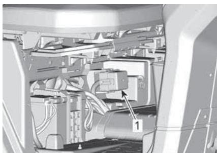
1. Задний вторичный блок предохранителей
