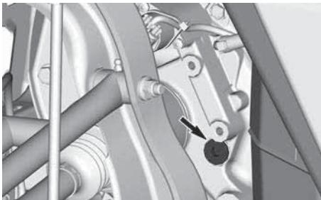
4. Выверните пробку заливного отверстия.
