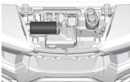
Поднимите и сдвиньте фильтр, чтобы снять его.
