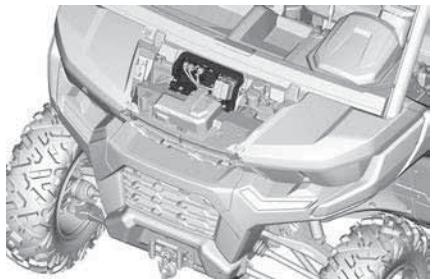
ОПОРА БЛОКА ПРЕДОХРАНИТЕЛЕЙ
