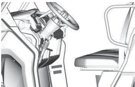
**ТИПОВЫЙ ВАРИАНТ — РАСПОЛОЖЕНИЕ НАКЛЕЙКИ С VIN-КОДОМ**
