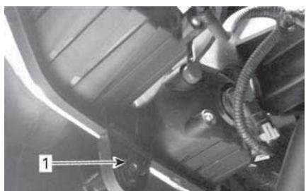
1. Регулировочный винт
