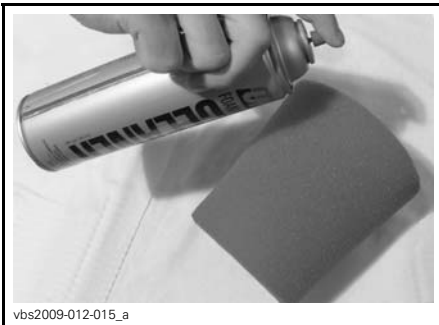
TYPIQUE - IMPRÉGNER L'ÉLÉMENT EN MOUSSE
