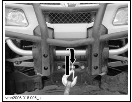
TYPIQUE — EMBLACEMENT DE L'ARRIMAGE AVANT
