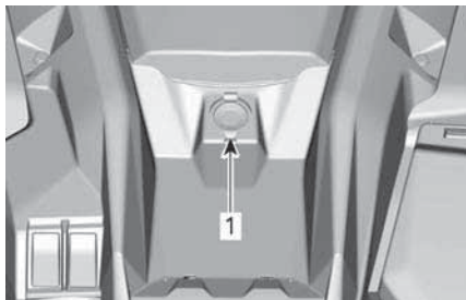
1. Электрическая розетка (12 В)
