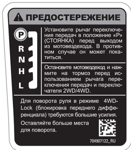
ПРЕДУПРЕЖДАЮЩАЯ НАКЛЕЙКА НА РЫЧАГЕ ПЕРЕКЛЮЧЕНИЯ ПЕРЕДАЧ
