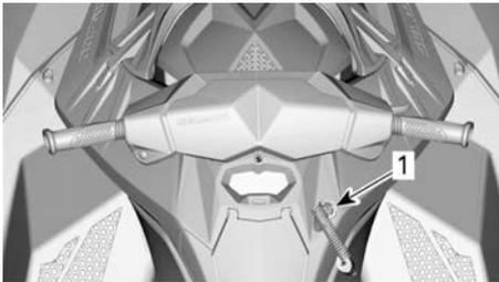
Чтобы обеспечить возможность запуска двигателя, необходимо установить колпачок шнура безопасности на выключатель двигателя.
