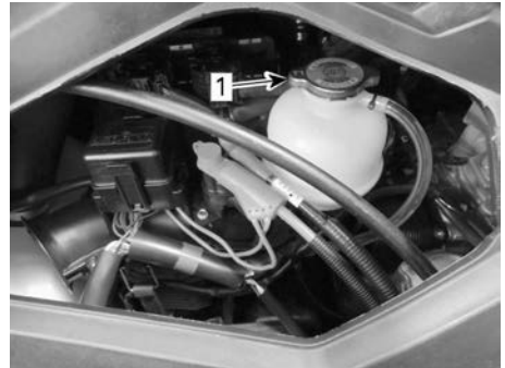
1. Tapón del depósito de expansión
