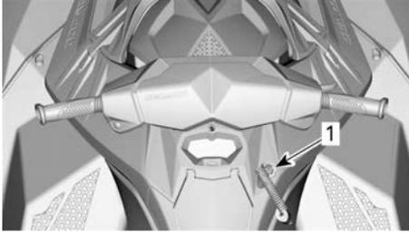
Um den Motor starten zu können, muss die Haltegurtkappe sicher am Motorausshalter befestigt sein.
