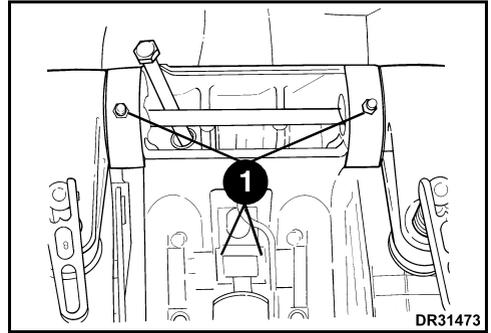
1. Points de lubrification (annuelle) du tube de relevage
