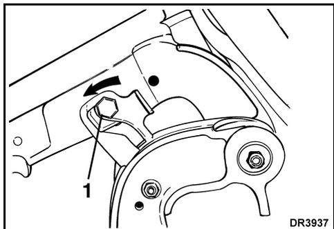
1. Support de relevage – position de verrouillage
