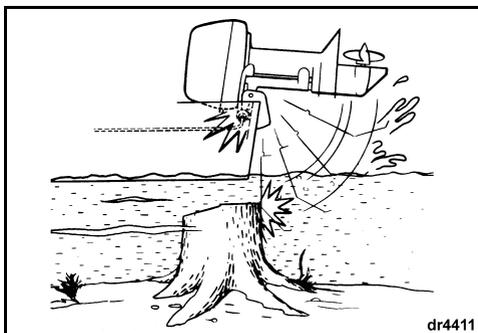
Le système d'amortissement du moteur hors-bord ne fonctionne pas en marche arrière. Si l'on heurte un objet en reculant, que ce soit dans l'eau ou lors du transport sur remorque, le bateau et le moteur peuvent être gravement endommagés.
