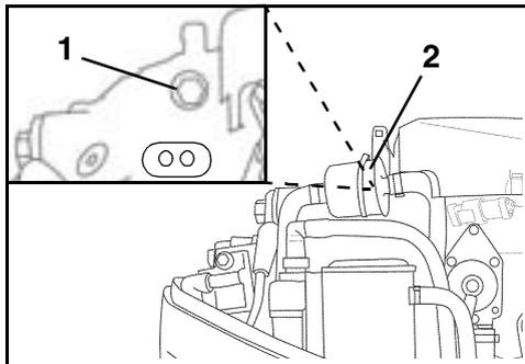
1. Orifice de pression d'eau (derrière le filtre à carburant)
