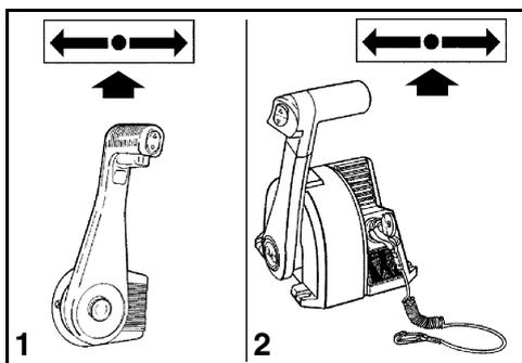
1. Commande encastrée montée sur le côté
