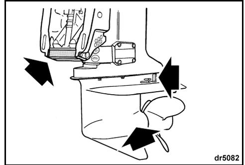
La corrosion galvanique détruit les pièces métalliques immergées et peut se produire aussi bien dans l'eau douce que dans l'eau salée ; cependant les eaux salées, saumâtres et polluées accélèrent la corrosion.
