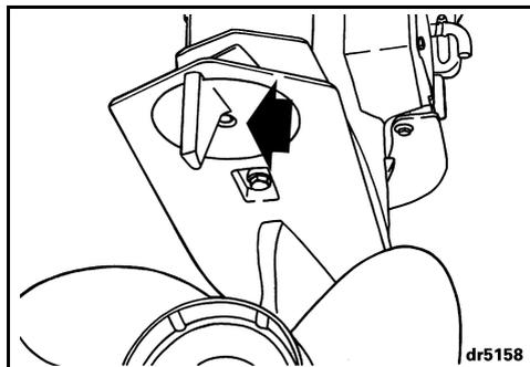
Resserrer la vis du compensateur de dérive à un couple de 47 à 54 N·m (35 à 40 lb·pi).
