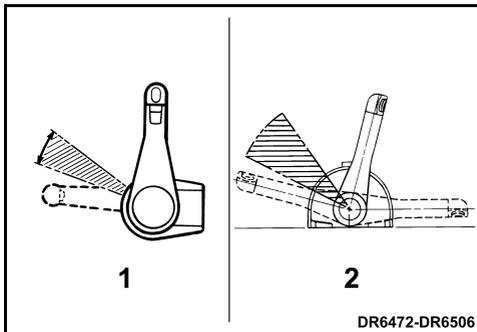
1. Commande encastrée montée sur le côté
