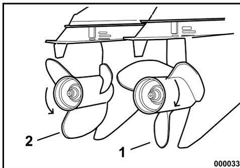
1. Rotation à droite (dans le sens des aiguilles d'une montre)
