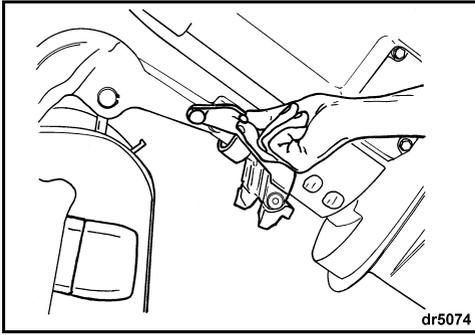
Le moteur est conçu pour être transporté en position verticale ou incliné, à l'aide du support pour transport sur remorque. Utiliser la position la mieux adaptée au bateau.
