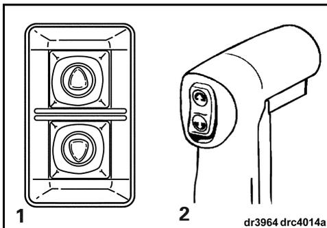
1. Interrupteur de relevage pour transport sur remorque
