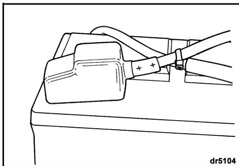
**IMPORTANT : NE PAS** utiliser d'écrous à oreilles pour réaliser les connexions de batterie, même s'ils sont fournis avec cette dernière. Les écrous à oreilles peuvent se desserrer et provoquer de faux signaux d'avertissement ou endommager les circuits électriques.
