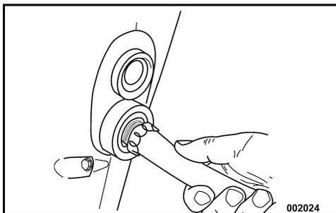
**IMPORTANT :** Le témoin « CHECK ENGINE » ou « CHK ENG » (vérifier le moteur) de la jauge *SystemCheck* peut s'allumer si le moteur hors-bord est **en marche** lors du rinçage. **Ceci est normal.** Le moteur hors-bord continue de tourner tant qu'il est alimenté en eau.
