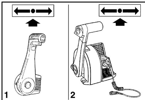
1. Commande encastrée montée sur le côté
