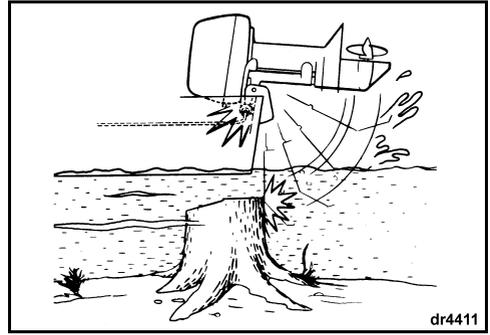
Le système d'amortissement du moteur hors-bord ne fonctionne pas en marche arrière. Si l'on heurte un objet en reculant, que ce soit dans l'eau ou lors du transport sur remorque, le bateau et le moteur peuvent être gravement endommagés.
