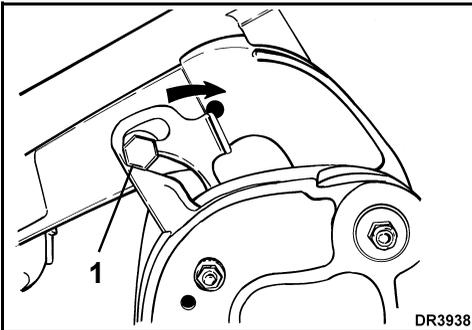
1. Leva del supporto di ribaltamento – posizione di sblocco
