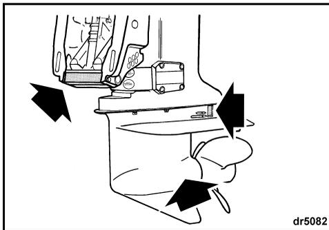
La corrosione galvanica distrugge le parti metalliche immerse e si produce sia in acqua dolce che salata, in acque salate, salmastre e inquinate, tuttavia, il processo di corrosione sarà più rapido.
