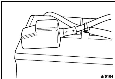
**IMPORTANTE:** NON utilizzare mai dadi ad alette sui collegamenti della batteria anche se in dotazione. I dadi ad alette possono allentarsi provocando falsi segnali di allarme o danni all'impianto elettrico.
