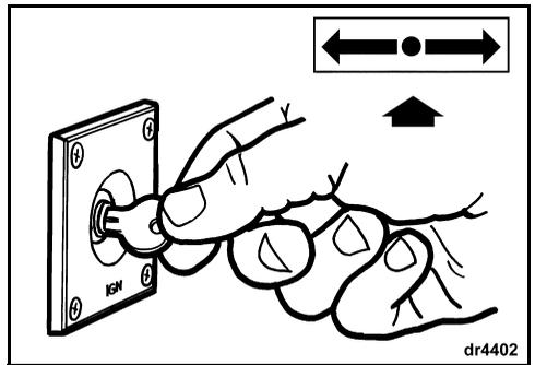
**IMPORTANT** : Le démarreur peut être endommagé s'il est actionné **continuellement** pendant plus de 20 secondes.
