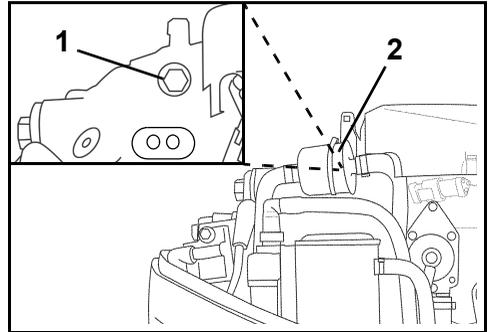
1. Orifice de pression d'eau (derrière le filtre à carburant)
