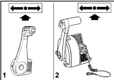
1. Commande encastrée montée sur le côté
