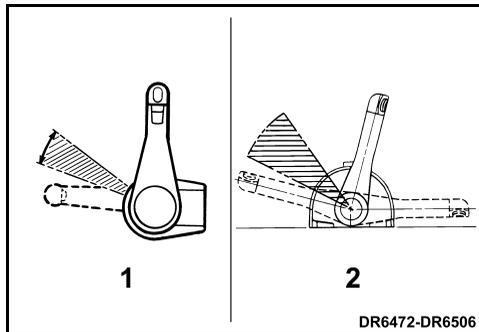
1. Commande encastrée montée sur le côté
