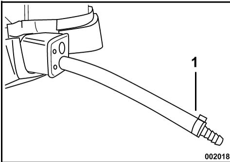
1. Flexible et raccord de carburant – 3/8 po (9 mm)
