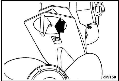
Resserrer la vis du compensateur de dérive à un couple de 35 à 40 lb-pi (47 à 54 N·m). Effectuer un essai du bateau et, si nécessaire, répéter l'opération jusqu'à ce que l'effort de direction soit aussi uniforme que possible.
