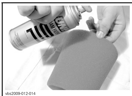
TYPISCH - FILTERELEMENT MET OLIE SMEREN
