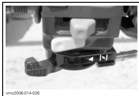
TYPISCH — CHOKEHENDEL IN MAXIMALE CHOKESTAND
